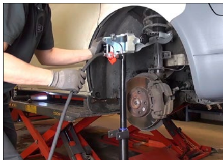
2. Federn vorspannen direkt am Fahrzeug
