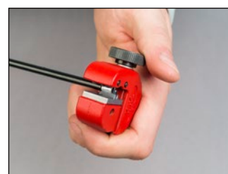
Positionierung der Leitung um Ummantelung abzuschaben
